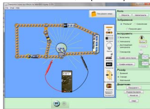
Рис. 3. Електричне коло постійного і змінного струму з паралельним з'єднанням
